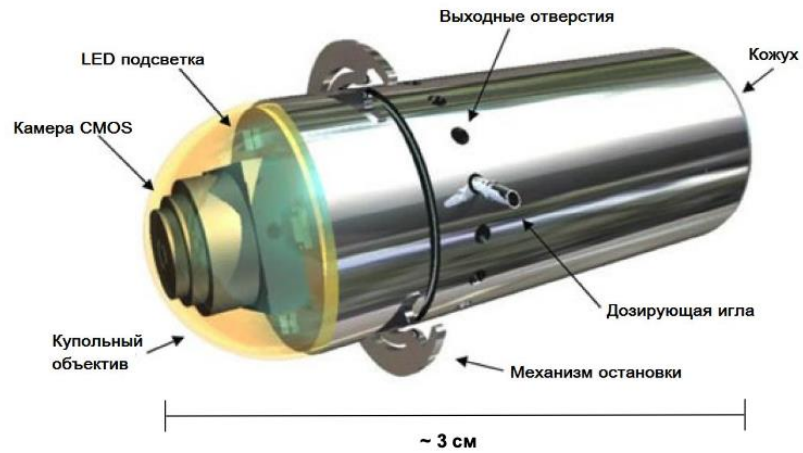
Схема микроробота с механизмом остановки и фиксации в заданной области ЖКТ [68]
